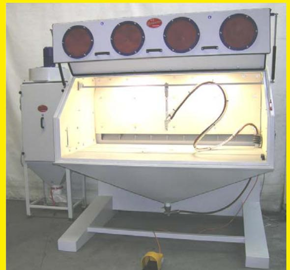
Strahlkabine mit Strahlmittelkreislauf, Hochleistungsstrahlkopf und Hartmetalldüsen, flexiblen Schläuchen, Sandverteiler mit Strahlmittelablass, angebautem Filter für Hubwagenverfahrbarkeit, guter Ausleuchtung mit Energiesparleuchte, beidseitigen Durchschuböffnungen mit Zuluftregulierungen,
